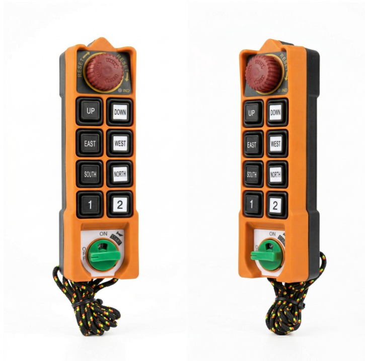
Figura 3: Transmisor SAGA1-L10 variante llave selectora: vista frontal y lateral. Pulsadores de movimiento con doble velocidad (UP, DOWN, EAST, WEST, SOUTH, NORTH), botones auxiliares (1 y 2), pulsador de emergencia EMS y llave selectora.
