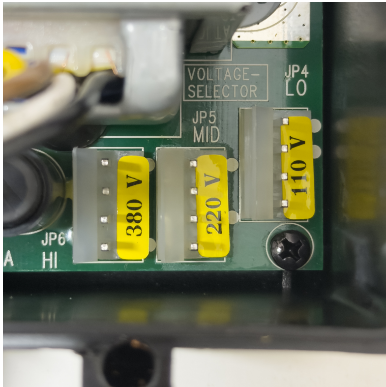
Figura 5: Selector de tensión en la placa del receptor. Mover el jumper a la posición 110 V (JP4/LO), 220 V (JP5/MID) o 380 V (JP6/HI) según la tensión de la instalación.
