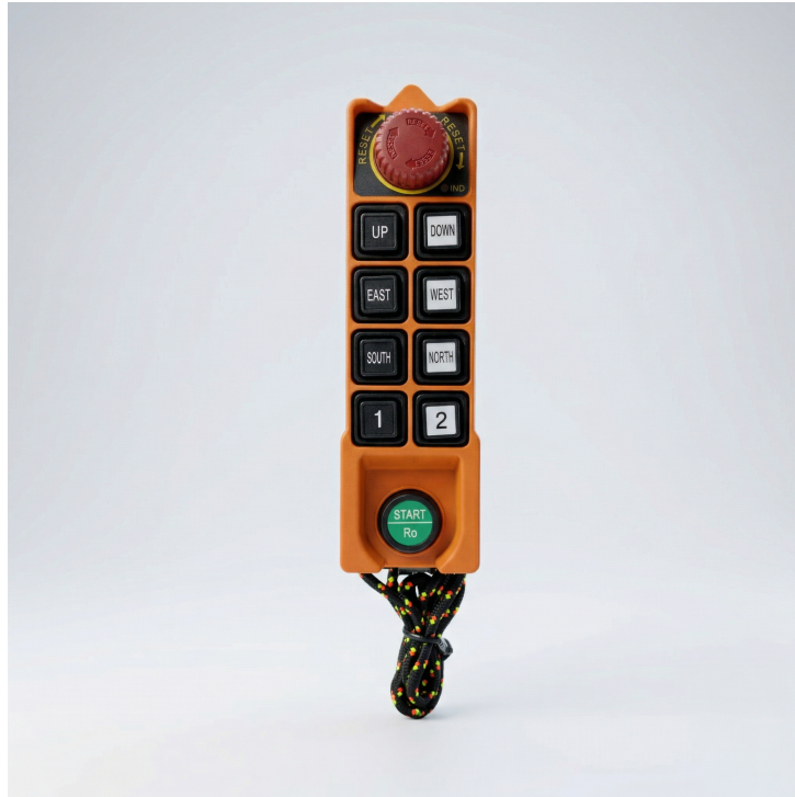
Figura 4: Transmisor SAGA1-L10 variante botón START/R0: reemplaza la llave selectora por un pulsador dedicado. El resto de los controles es idéntico a la variante con llave.
