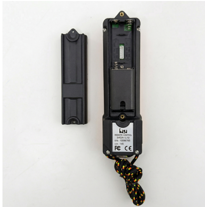
Figura 6: Acceso al compartimento de baterías: retirar los dos tornillos de la tapa trasera del mando.
